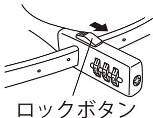
①ダイヤルを「000」に合わせ、ロックボタンをずらした状態でベルトを外し、施錠したいものに通して輪の大きさを調節します。
