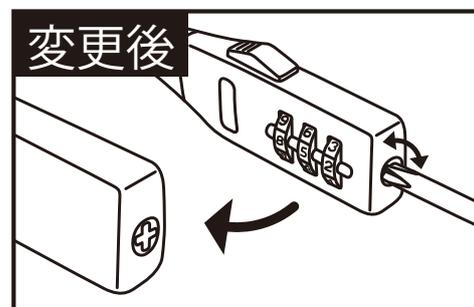
ネジを左右いずれかに90度回転させて、元の状態に戻すと番号が設定されます。
