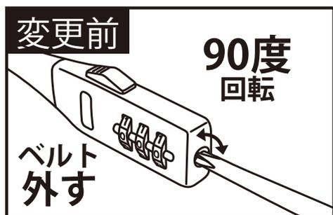
ベルトを外した状態で、ダイヤルを「000」(変更後は設定した番号)に合わせ、右側面(底面)にあるネジをドライバーなどで、左右いずれかに90度回転させると押し込まれます。
